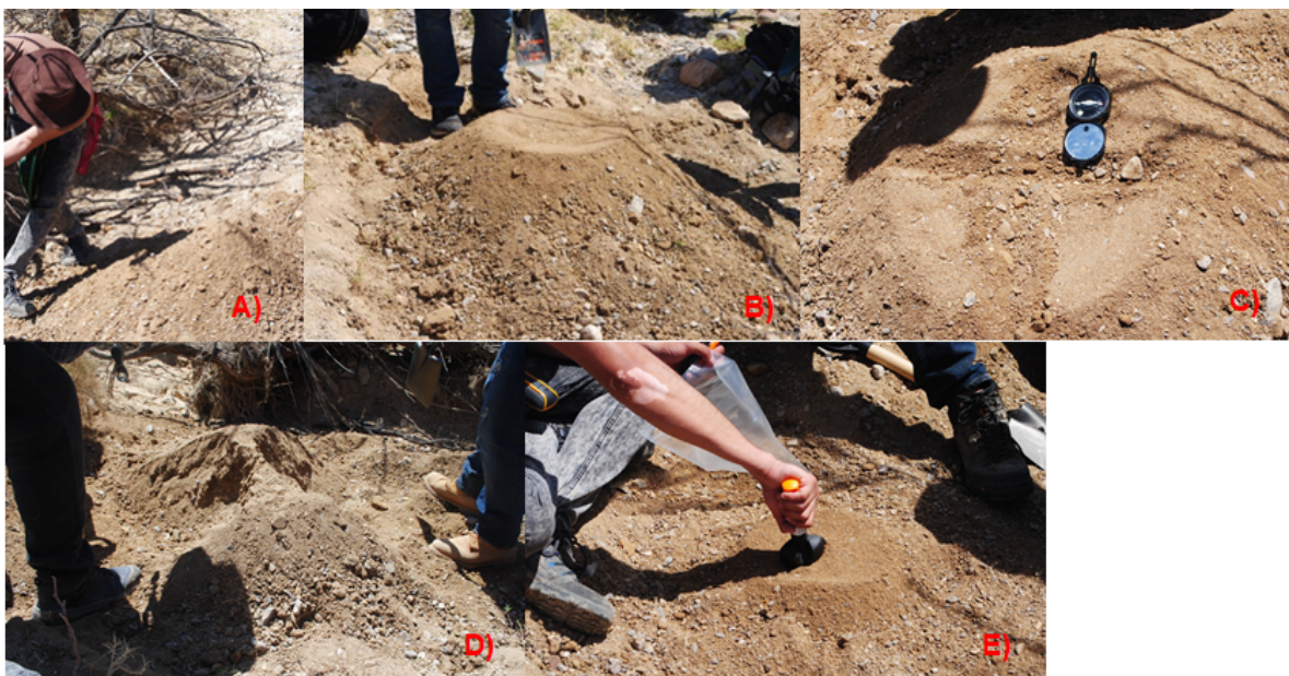
Figura 4. A) Generación de cono de sedimentos con diámetro aprox. a 2m. B) Aplanado de punta del cono. C) Trazo y orientación de cruz para cuarteo. D) Elección de cuartos opuestos (I y III) a eliminar con una pala reduciendo al 50% la muestra, y así sucesivamente. E) Se Repite la operación las veces que sean necesarias hasta reducir la muestra a ~5 kg para su posterior recolección, identificación y embalaje.
