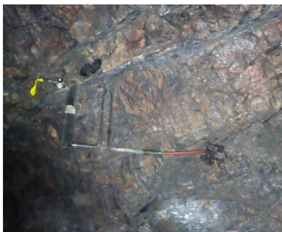
Figura 2. Trampa de captación y monitoreo de gas asociado a los mantos de carbón.
