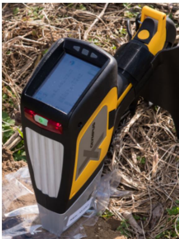
Figura 2. Fotografía del microanalizador FRX marca Olympus INNOV.X, modelo DPO-2000-CC utilizado.
