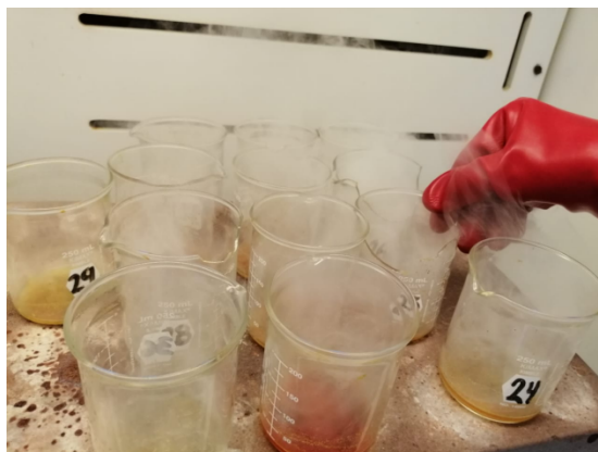
Figura 7. Digestión con agua regia y ácido perclórico.
