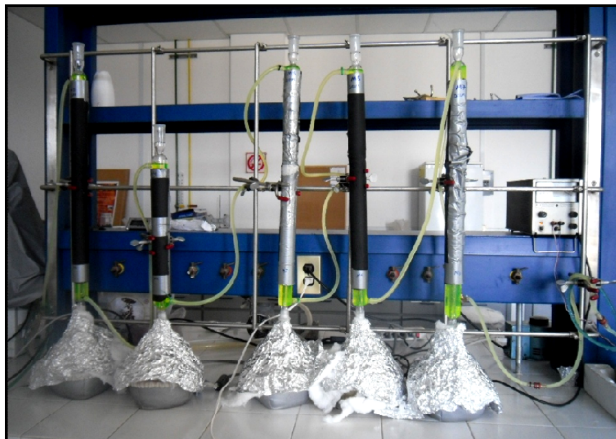
Figura 2. Diagrama de la extracción secuencial por reflujo continuo y termoregulado, llevado a cabo durante 48 horas por cada solvente (hexano, acetato de etilo y metanol).
