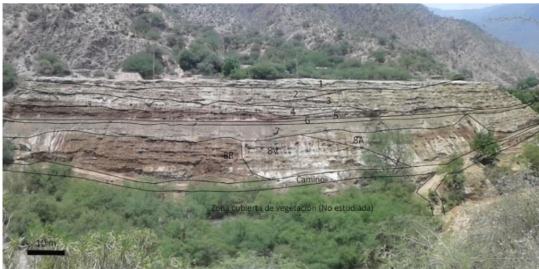
Figura 1. Vista panorámica de la pila de jales 4 dividida en capas observadas en campo
