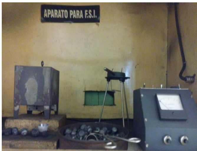
Figura 8. Equipo para análisis de FSI (índice de hinchamiento libre).
