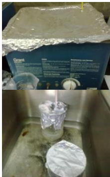
Fig.4 Baño María para el ataque químico del CR-39. Fig. 5. Área de conteo de las trazas nucleares en el DTNS. Después del ataque se procedió a contar el número de trazas en cada detector, el área de conteo de muestra para un detector en la Fig.5.
