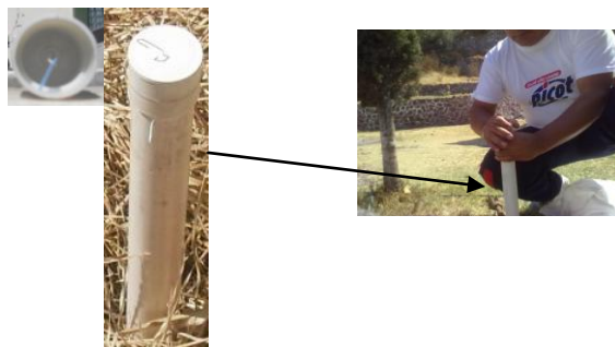
Figura 3. Dispositivo con el CR-39 y colocación en el punto de monitoreo
