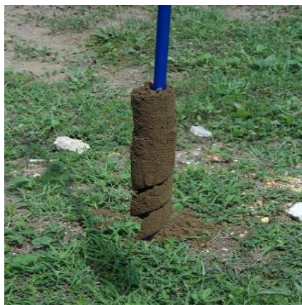
Figura M1. Perforación de suelo
