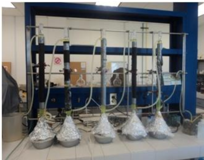
Figura 3. Detalle de la extracción secuencial en sistema termoregulado.
