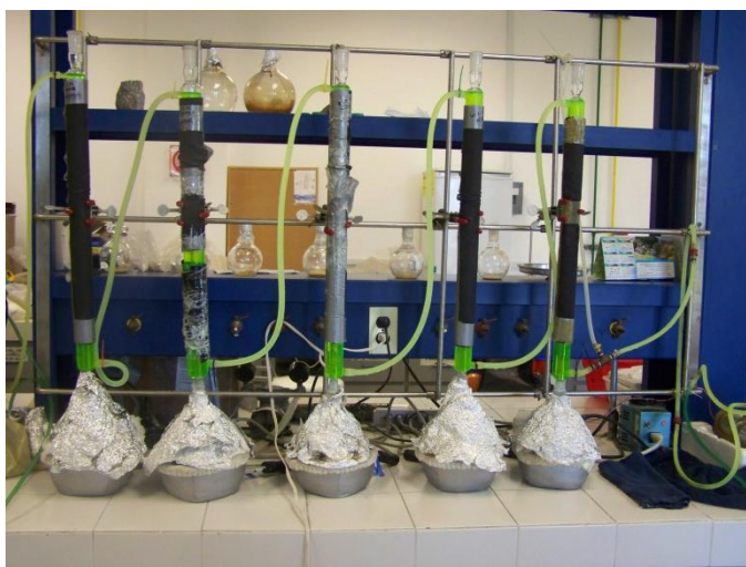
Fig.5. Montaje del experimento: sistema de reflujo en extracción secuencial de bitumen.
