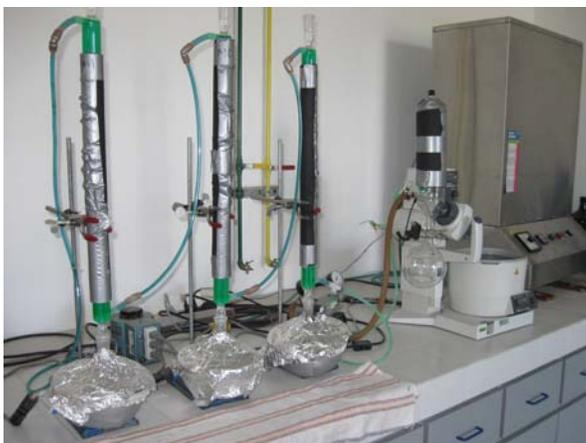
Fig. 3. Montaje del sistema a reflujo con recirculador termostatado y rotapor.
